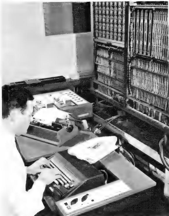
Mit Hilfe einer elektronischen Rechenanlage läßt sich die Setzleistung bei gleichem Personal um 30 % steigern
