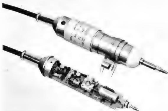
Bild 4. Konstruktive Ausführung des Transistor-Tastkopfes
